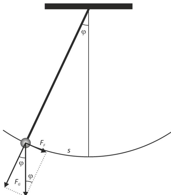
Abbildung 7: Schematische Darstellung eines Fadenpendels
