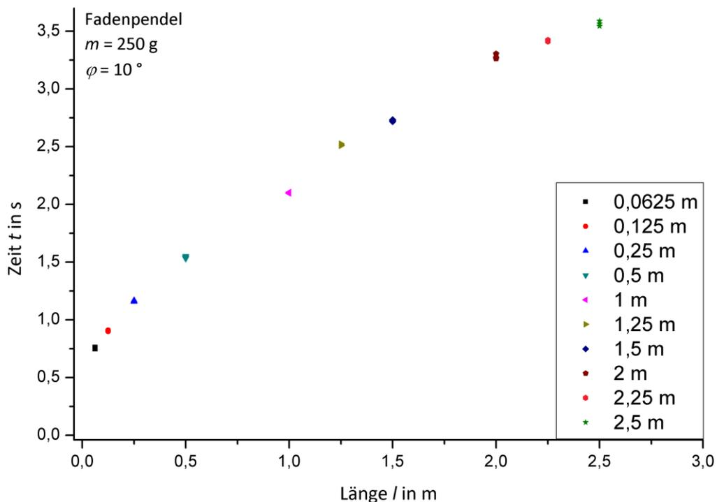
**Abbildung 4: Messwerte der Pendelmessung (jeweils 10 Messungen pro Länge)**
