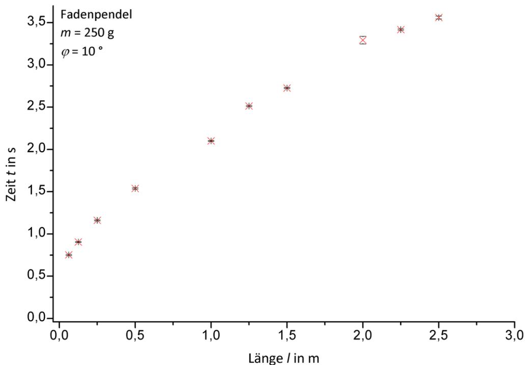
**Abbildung 5: Gemittelte Messwerte und Fehlerbalken**
